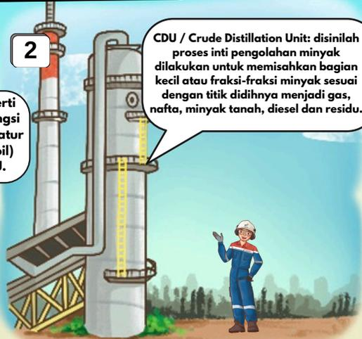
**CDU / Crude Distillation Unit:** disinilah proses inti pengolahan minyak dilakukan untuk memisahkan bagian kecil atau fraksi-fraksi minyak sesuai dengan titik didihnya menjadi gas, nafta, minyak tanah, diesel dan residu.
