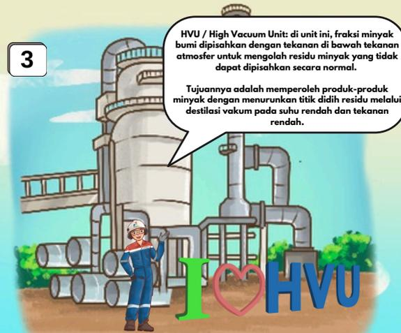
**HVU / High Vacuum Unit:** di unit ini, fraksi minyak bumi dipisahkan dengan tekanan di bawah tekanan atmosfer untuk mengolah residu minyak yang tidak dapat dipisahkan secara normal.
