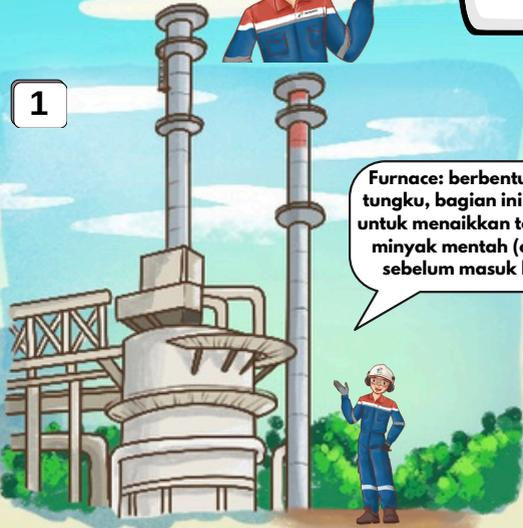
**Furnace:** berbentuk seperti tungku, bagian ini berfungsi untuk menaikkan temperatur minyak mentah (crude oil) sebelum masuk ke CDU.
